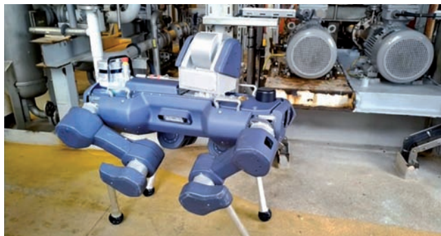
ANYmal X vykonáva autonómne inšpekčné misie na platforme Valhall v Severnom mori. (Zdroj: ANYbotics)
