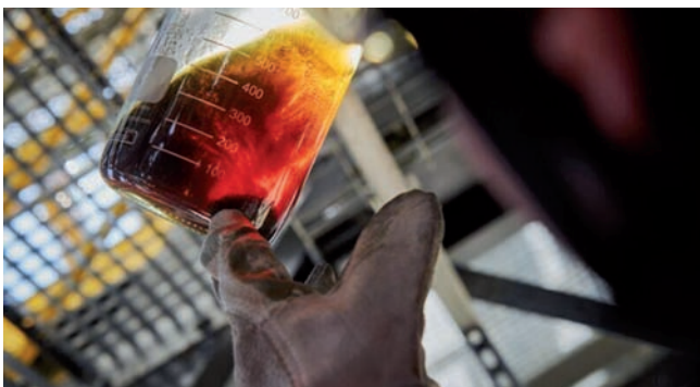
Patentovaná technológia chemickej recyklácie spoločnosti OMV premieňa plastový odpad na konci životnosti na pyrolýzny olej, ktorý nahrádza fosílny zdroj. (Zdroj: OMV)
