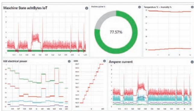
Priebežné sledovanie parametrov pomocou platformy IIoT od achtBytes ( www.achtbytes.com )
