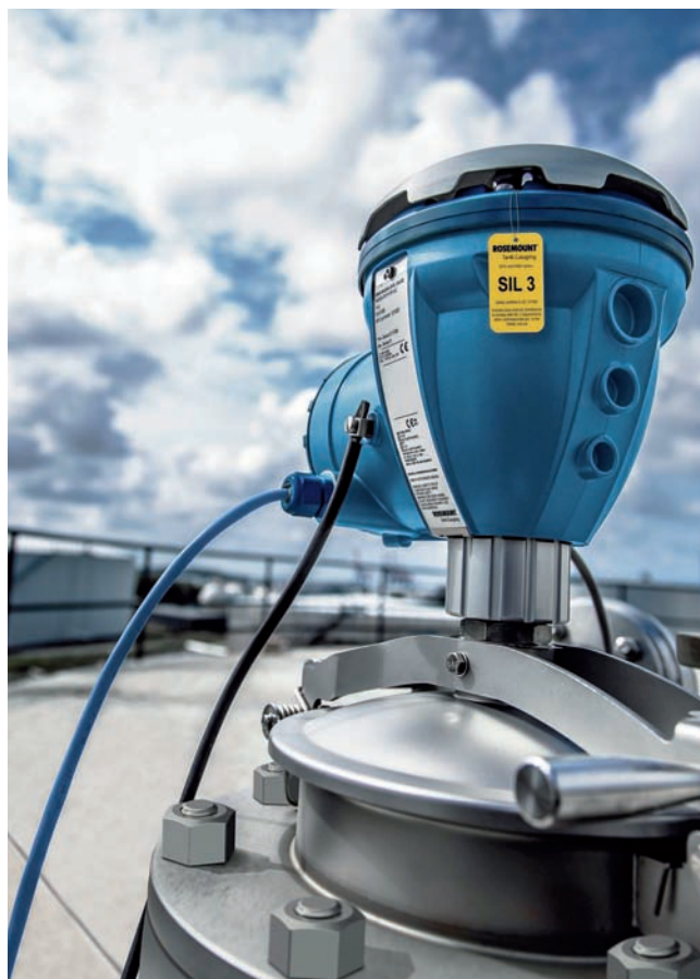
Obr. 4 Emulácia snímačov – snímače výšky hladiny Rosemount série 5900 môžu byť inštalované na existujúce otvory nádrže pomocou rovnakej kabeláže a komunikačného protokolu ako predchádzajúce zariadenia, vďaka čomu je výmena starých meradiel veľmi rýchla a jednoduchá.
