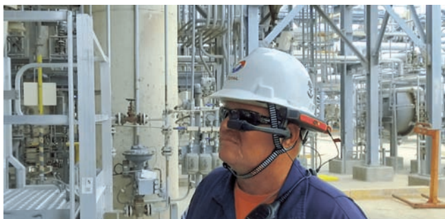
Náhlavná súprava RealWear HMT-1Z1 umožňuje používateľom komunikovať na diaľku s odborníkmi na danú problematiku s cieľom vyriešiť problémy rýchlejšie a s vyššou presnosťou. (Zdroj: TotalEnergies)
